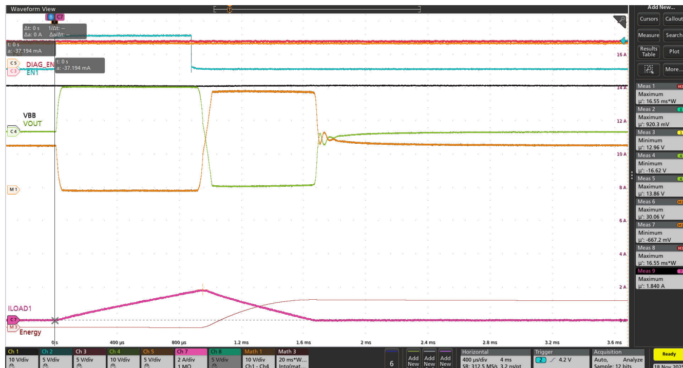
Figure 8-26. 5mH Inductive Load Driving (VBB = 13.5V, T AMB = 125°C)
