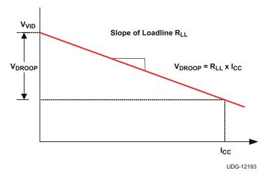
Figure 7-2. Load-Line Slope
