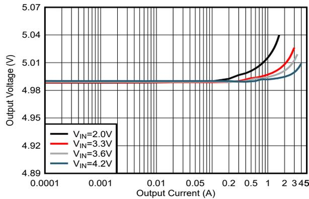
$V_{IN} = 2.0\text{ V}, 3.3\text{ V}, 3.6\text{ V}, 4.2\text{ V}$ ;  $V_{OUT} = 5\text{ V}$
