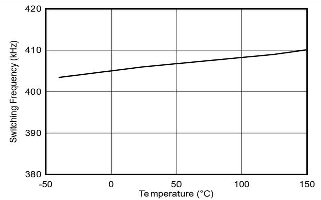
**Figure 6-6.  $f_{sw}$  400kHz**
