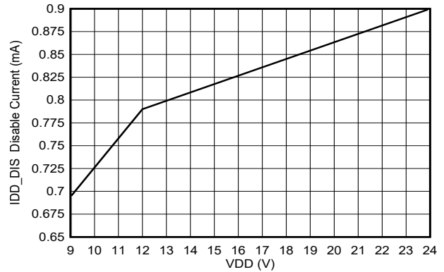
Figure 5-6. Disable Current (EN = 0V)
