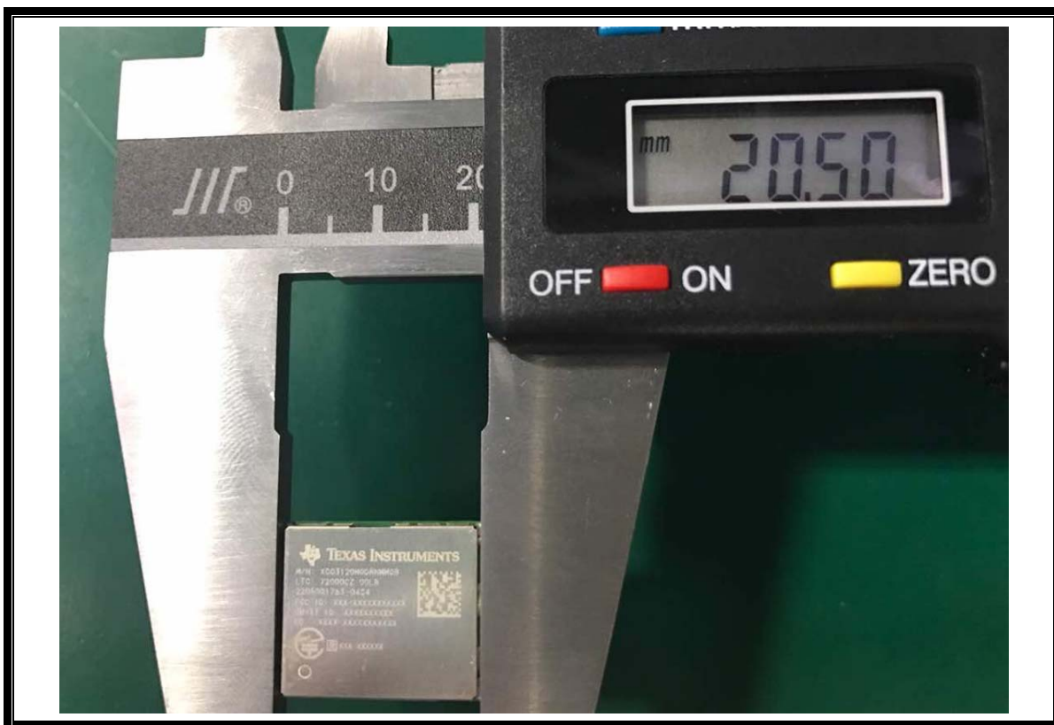
整体照 物理尺寸：长×宽×高=20.5mm(L)×17.5mm(W)×2.2mm(H)
