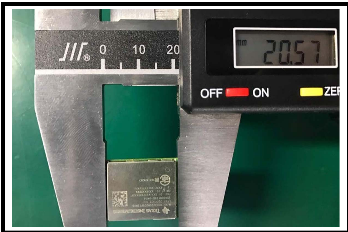
整体照 物理尺寸：长×宽×高=20.5mm (L) × 17.5mm (W) × 2.2mm (H)
