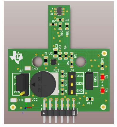
Figure 1-1. TMAG5328 Evaluation Module
