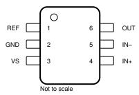
Figure 4-1. Pin Diagram
