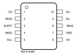
Figure 4-1. Pin Diagram (VSSOP-10) Package
