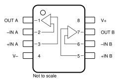
Figure 4-1. Pin Diagram
