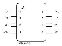
Figure 4-1. Pin Diagram
