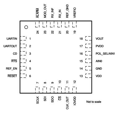
Figure 4-1. Pin Diagram
