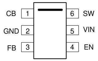
Figure 4-1. Pin Diagram
