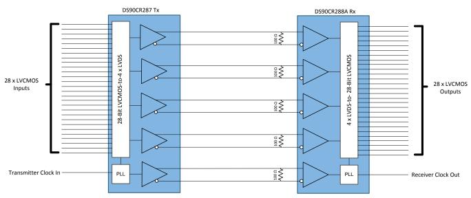
Figure 7. Connection Diagram for DS90CR287 to DS90CR288A
