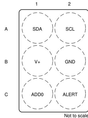
Figure 5-2. YBG Package 6-Pin DSBGA Top View
