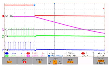
Figure 30. VDD Rail—60-A Shutdown
