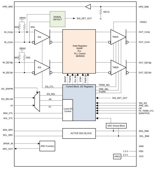
Figure 3. TMDS181 Functional Block Diagram
