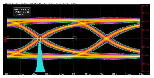
Figure 20. ±12 kV TMDS181 with ESD224 Post-test Eye Diagram
