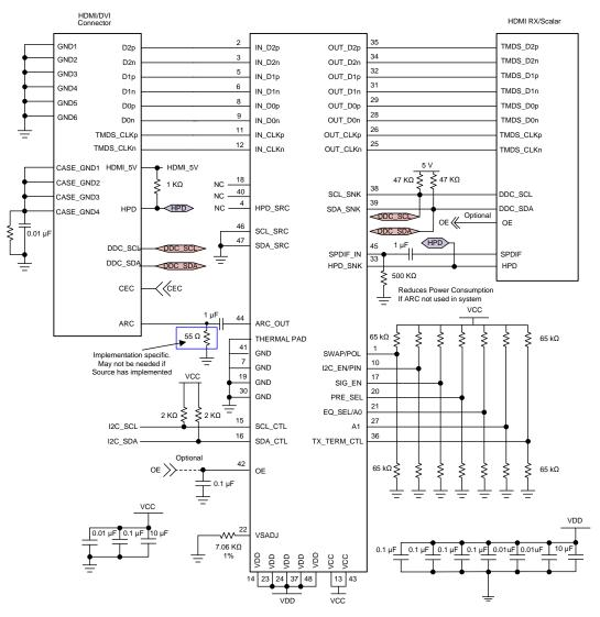
Figure 14. TMDS181 in Sink Side Application
