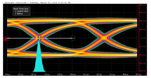
Figure 17. D2 TMDS181 with ESD224 Eye Diagram Pretest
