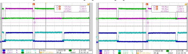
Figure 20. Dead Time at Falling Edge and Rising Edge of Low-Side PWM
