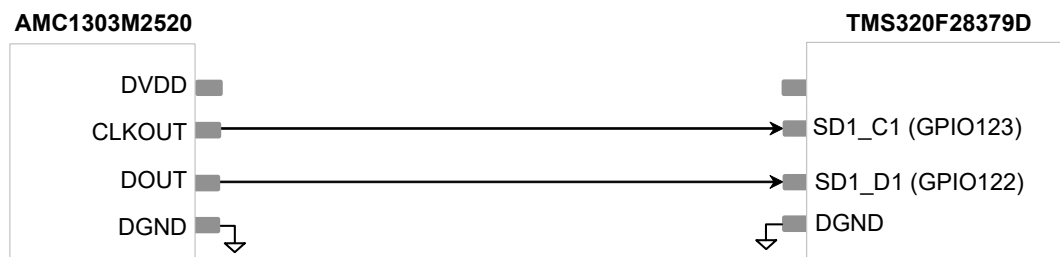
Abbildung 149. Digitale CMOS-Schnittstelle zum TMS320F28379D AMC1303M2520 für 3,3 V
