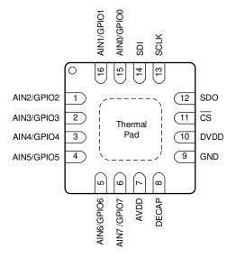
Figure 4-1. Pin Diagram
