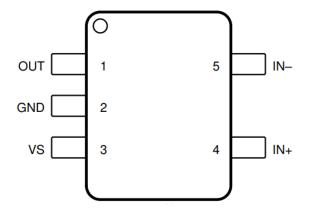
Figure 4-1. Pin Diagram
