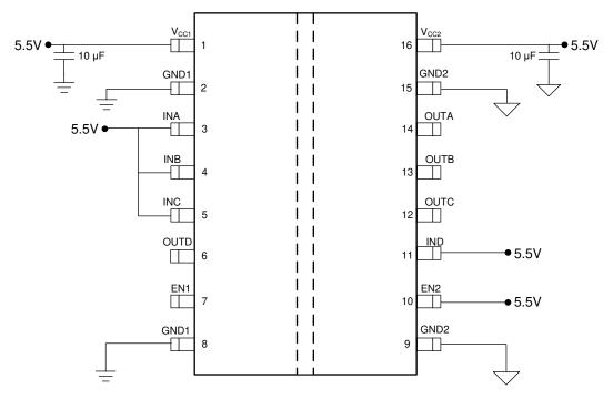
Figure 3-2. ISOS141-SEP SEL Bias Diagram
