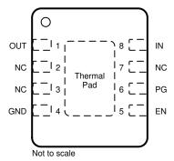
Figure 4-3. Pin Diagram Adjustable TPS745-Q1 DRB Package
