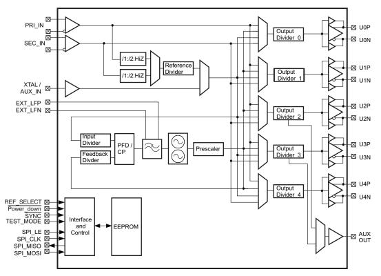
Figure 1. CDCE62005 Block Diagram
