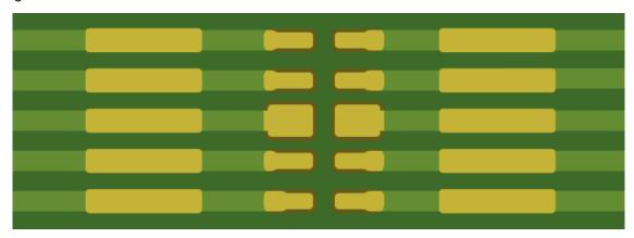
Figure 1-1. VSSOP (DGS) - USON (DQA)
