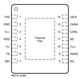
Figure 4-1. Pin Diagram
