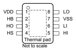
Figure 4-1. Pin Diagram
