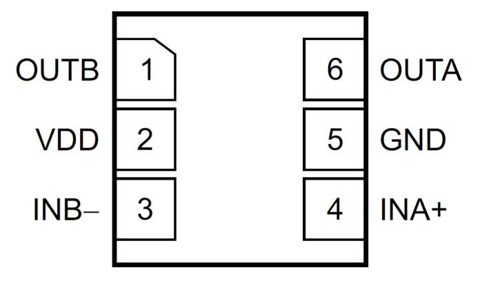
Figure 4-1. Pin Diagram
