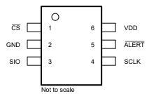
Figure 4-1. Pin Diagram (SOT-23) Package
