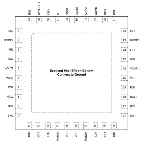
Figure 4-1. Pin Diagram
