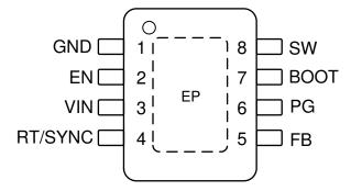
Figure 4-1. Pin Diagram
