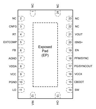
Figure 4-1. Pin Diagram
