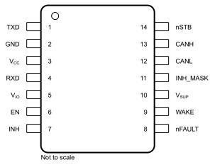
Figure 4-1. TCAN1463-Q1 SOIC/SOT Pin Diagram
