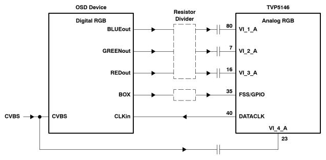
Figure 7. SCART-Mode Overlay of Digital RGB
