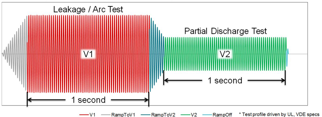
**Figure 2. Method B Test Waveform**
