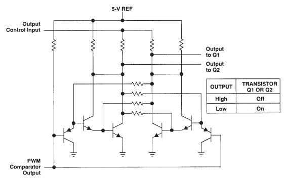
Figure 15. Pulse-Steering Flip-Flop
