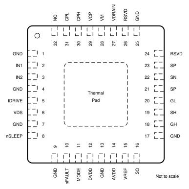
Figure 4-1. Pin Diagram
