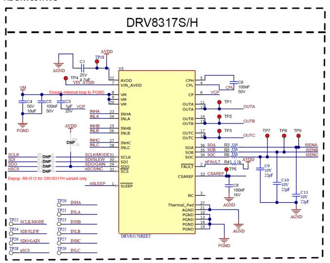
Figure 7-2. DRV8317H/S schematic
