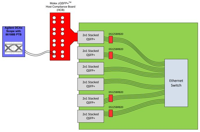
Figure 5. Front-Port Design Using DS125BR820 Linear Repeaters
