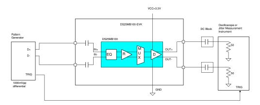
Figure 1. Typical connection for evaluation of the DS25MB100
