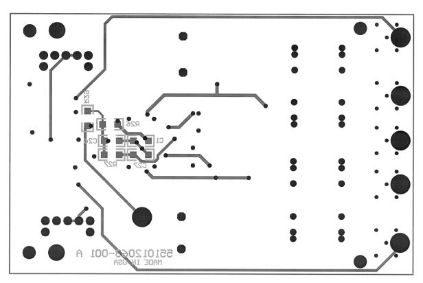
Figure 9.  $V_{\rm DS}$  Sense PCB Bottom Layer
