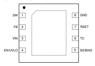
Figure 4-1. Pin Diagram
