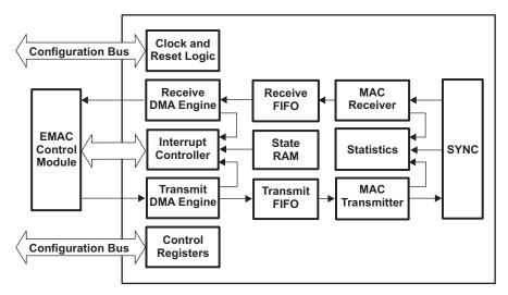
Figure 25. EMAC Module Block Diagram
