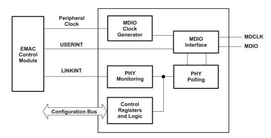
Figure 24. MDIO Module Block Diagram
