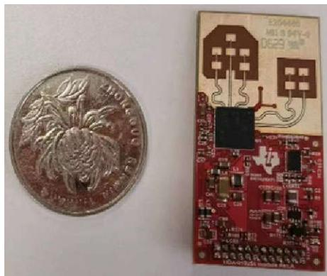
Figure 4-3. TIDA-010254 IWR L6432 module
