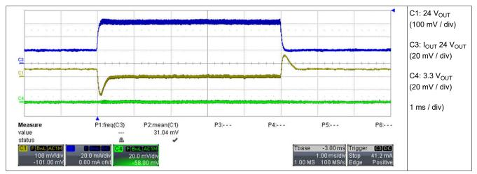
Figure 3-6. Load Transient
