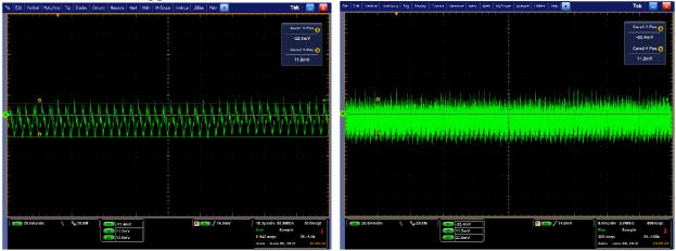
Vin=48V, Io=10A /Ripple=28mV
