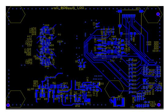
Figure 20. ADS8688EVM Bottom-Side Layout
