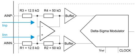
Figure 25. AMC1304 Input Amplifier
