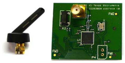
Figure 27. ZigBee Radio
